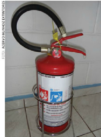
Extintor de incêndio pressurizado com carga de pó BC de 4 quilos
